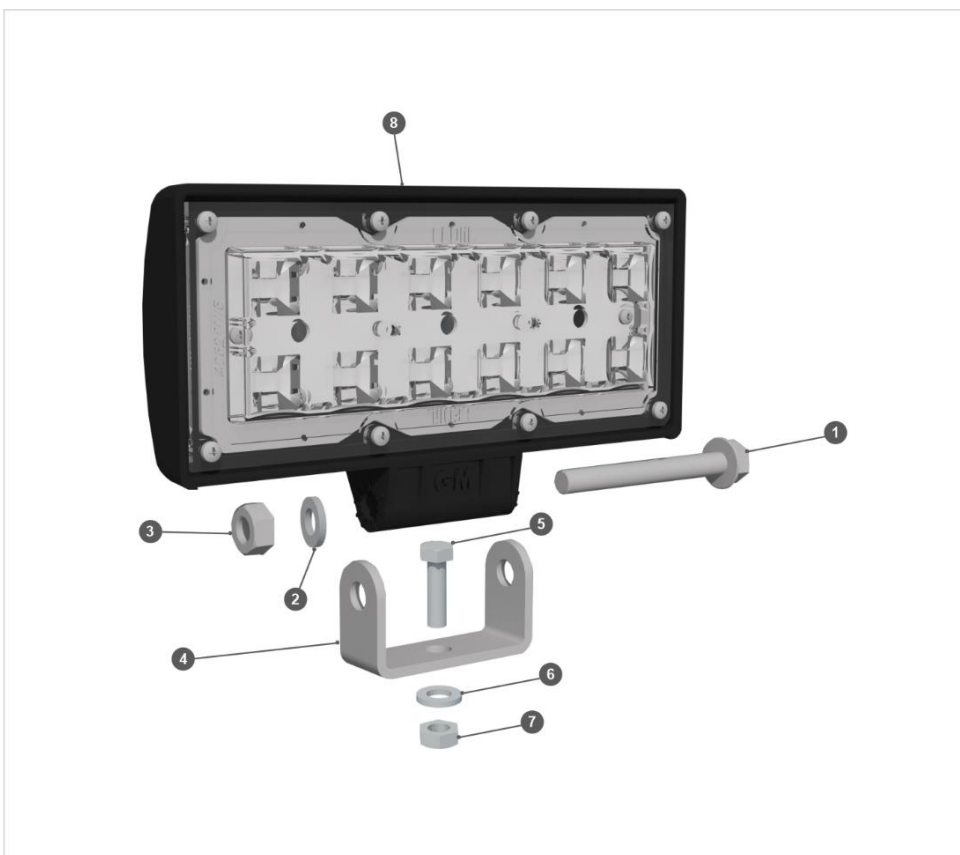
Рисунок 1. Схема монтажа фары GM-TRAC.
